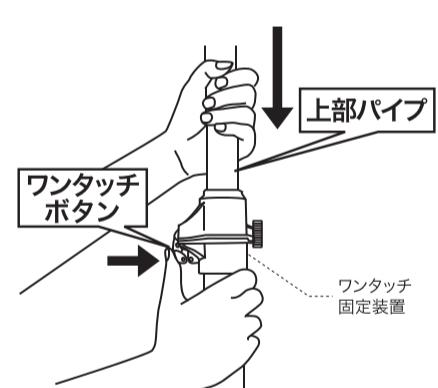
3. 上部パイプを持ちながら、4. ワンタッチボタンを押してください。上部パイプを持たずにワンタッチボタンを押すと、上部パイプが急に落ちてきて大変危険です。
