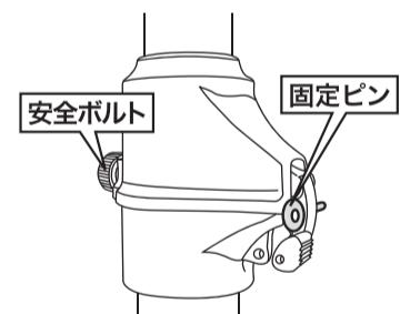
1. 安全ボルトの締め付けをゆるめ、
