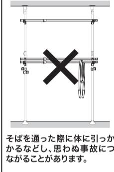
上部パイプと下部パイプの重なりが短いと、製品の安定性が損なわれます。
