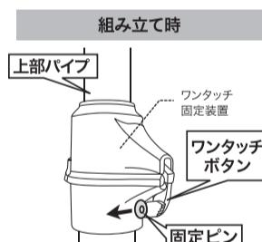
⑩ 固定ピンを矢印の方向に外して、ワントッチボタンを押すと、上部パイプが伸縮自在になります。
